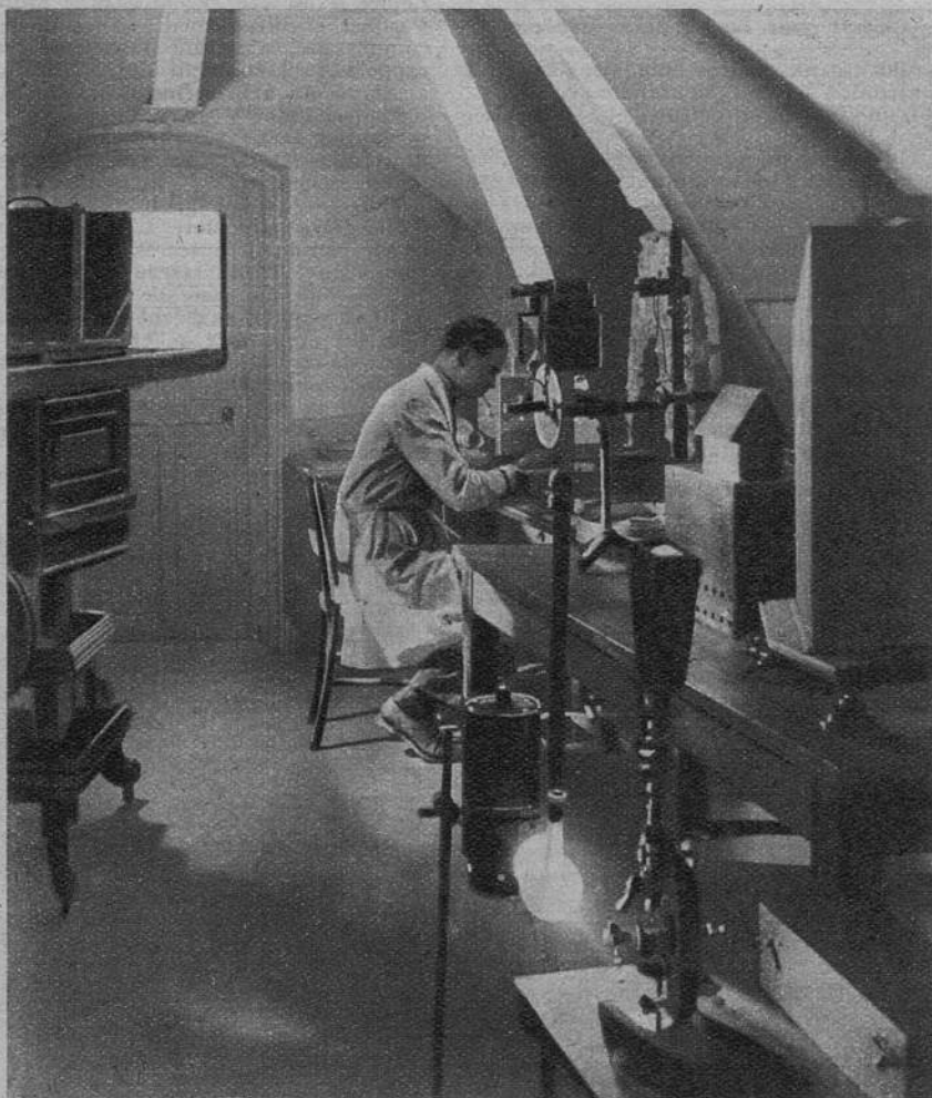
Un ingénieur est en train d'étudier les réactions produites par un billet de banque au moyen de la lampe d'Harau. (H. M.)
