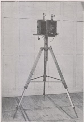
FIG. 1. — Appareil de la Sûreté générale (modèle Bertillon) pour la photographie métrique (judiciaire, médico-légale, anthropologique, etc.).
