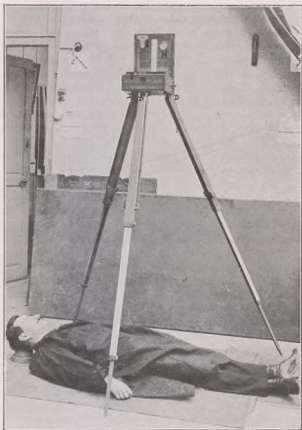
Fig. 2. — Le même appareil en position renversée pour la photographie des cadavres et du sol (traces de pas, taches de sang, etc.).
