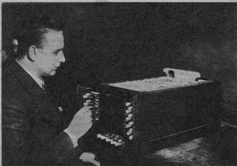
Le « carlothèque pensant » vient d'être installé à Berlin. La préfecture de police en est très satisfaite. Par un système électrique, on obtient instantanément la fiche cherchée. (K.)
